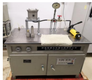
图 5 HYS-4 型岩石渗透分析仪 Fig.5 HYS-4 type rock penetration analyzer
